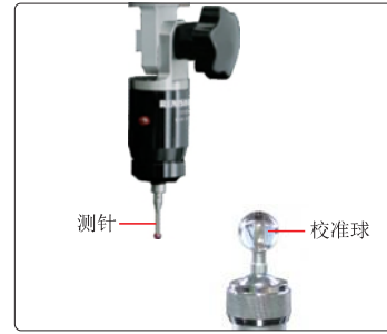
探针(选配), 包含 \varnothing 2\text{mm} 和 \varnothing 3\text{mm} 测针, \varnothing 25\text{mm} 校准球, 测量精度 10\mu\text{m}
